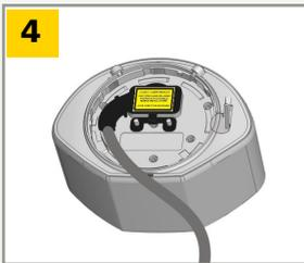
Aprire il coperchio della protezione, collegare il connettore ed inserire il cavo nel passaggio. Chiudere il coperchio di protezione e fissarlo saldamente.
