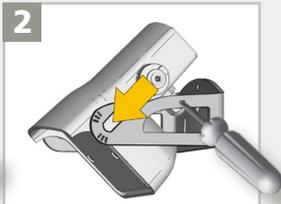
Positionnez le détecteur sur l'étrier et fixez les vis fermement.
