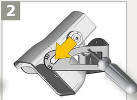
Posicionar el detector sobre el soporte y fijar los tornillos firmemente.
