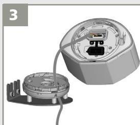
3 Ouvrez le couvercle de protection, branchez le connecteur et insérez le câble dans la fente.
