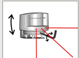
Ajustez l'angle d'inclinaison du détecteur avec une clé Allen.
