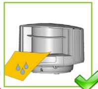
Nettoyez les fenêtres laser avec de l'air comprimé ou si nécessaire avec un chiffon microfibre propre et humide.
