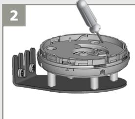
2 Installez le support de montage et fixez fermement les 4 vis pour éviter toute vibration.
