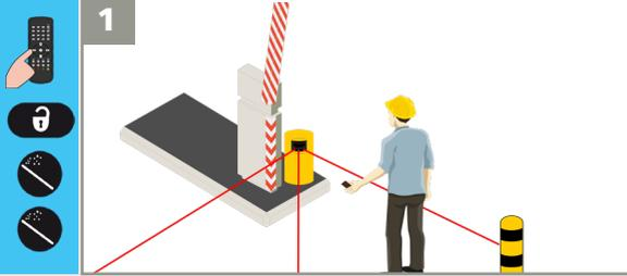
Activez les faisceaux laser visibles par télécommande.
