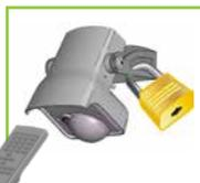
Dopo l'installazione, entrate un codice di accesso per bloccare il rilevatore.
