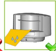
Die Laserfenster mit Druckluft reinigen oder falls notwendig mit einem sauberen und feuchten Mikrofasertuch.
