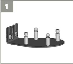
Benutzen Sie einen Montagepfosten oder Montagezubehör, um den Sensor an einem Pfosten zu fixieren (z.B. LBA Zubehör).
