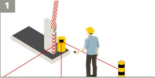
Die 3 sichtbaren Laserstrahlen mittels Fernbedienung aktivieren um den Sensor korrekt zu installieren.
