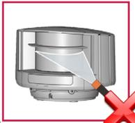
Direktes Bestrahlen mit Hochdruckreiniger ist zu vermeiden.
