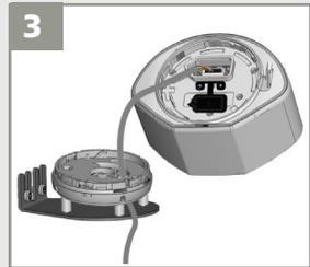
Die Schutzkappe öffnen, den Stecker anschliessen und das Kabel in den Schlitz drücken.
