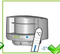
In Umgebungen, in denen die Temperatur unter  $-10^{\circ}\text{C}$  fallen kann, sollte der Sensor ununterbrochen eingeschaltet sein.
