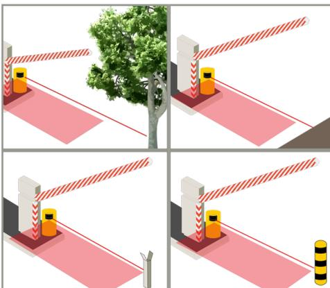
Si el campo de seguridad es la única protección contra el contacto con el mástil, el campo de seguridad del sensor debe situarse justo por debajo del mástil de la barrera.
