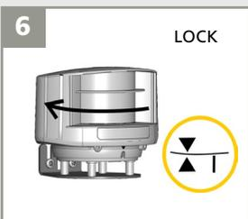
6 Girar el sensor hasta que los dos triángulos queden frente a frente.
