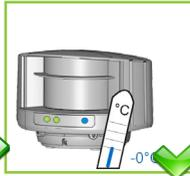
Mantener el sensor conectado permanentemente a la fuente de alimentación en entornos donde la temperatura pueda alcanzar  $< 0^{\circ}\text{C}$ .
