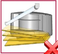
Evitar la colocación de objetos en movimiento y fuentes luminosas en el campo de detección.
