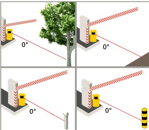
El sensor tiene que 'aprender' una referencia si el campo de seguridad actúa como única protección contra el contacto entre el vehículo y el mástil de la barrera.
