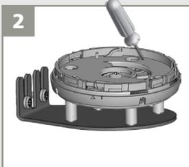
2 Colocar la montura y apretar los 4 tornillos con firmeza para evitar posibles vibraciones.
