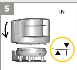
5 Colocar la carcasa en la montura.
