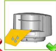
Limpiar las ventanas del láser con aire comprimido. Puede limpiar únicamente con un paño de microfibra suave, limpio y húmedo.
