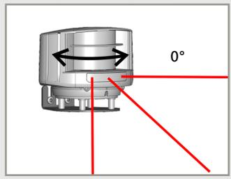
Girar ligeramente el sensor sobre su eje para ajustar el ángulo lateral del sensor para colocar el punto del láser a 0° en la referencia.
