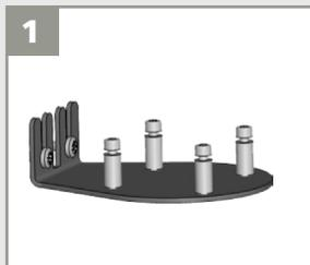
1 Usar un soporte o accesorio de montaje para fijar el sensor al poste (por ejemplo, el accesorio LBA).
