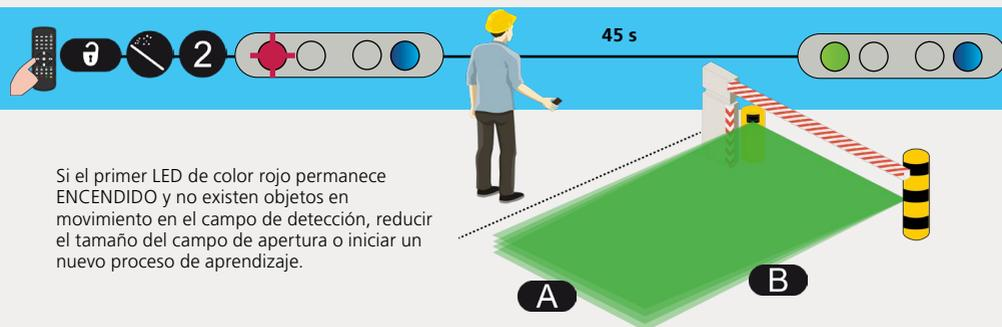
Si el primer LED de color rojo permanece ENCENDIDO y no existen objetos en movimiento en el campo de detección, reducir el tamaño del campo de apertura o iniciar un nuevo proceso de aprendizaje.
