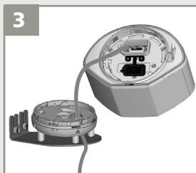
3 Abrir la cubierta de protección, enchufar el conector y pasar el cable por la ranura.
